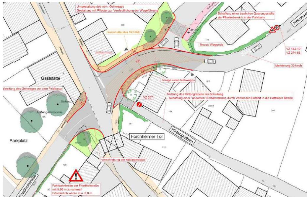
Abb. 7: Vorschlag Umbau Fahrbahnen im Kreuzungsbereich (Neuplanung Fahrbahn-
