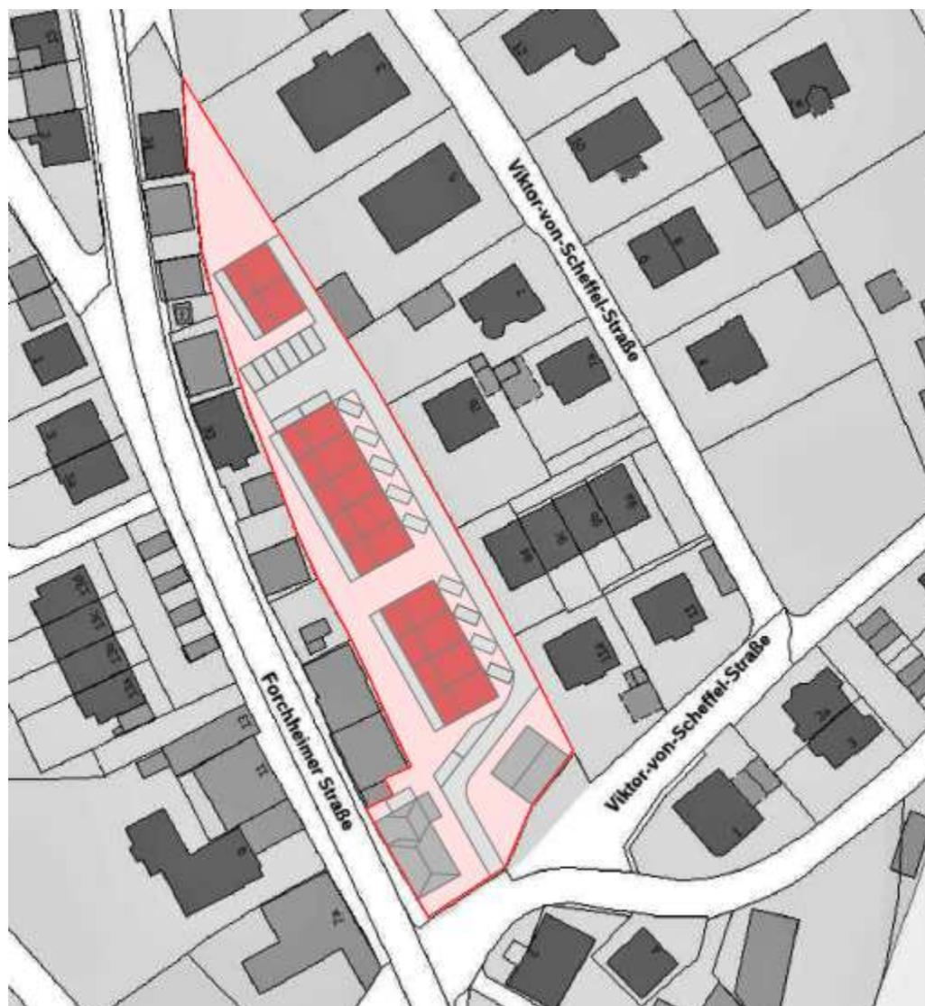
Abb. 13: Planungskonzept mit bis zu 11 Wohneinheiten in Form von zwei Reihenhausböcken und einem Doppelhaus mit Zufahrt aus Richtung Süden (Darstellung genordet, o. M., Quelle: Markt Neunkirchen a. Brand)
